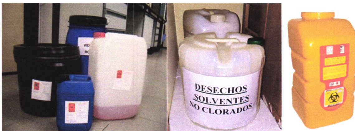
Fotografía 15: Dispositivos para almacenar residuos peligrosos líquidos
